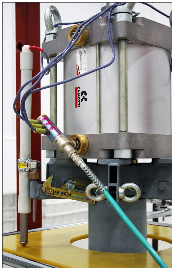
Рис.3. Крепление пневмомагистрали к пневмоцилиндру
