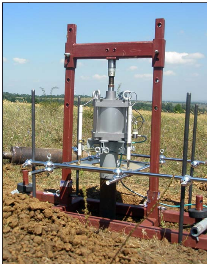
Рис.2. Общий вид штампа ШВ60 с анкерной системой и комплектом регистрации КРП1
