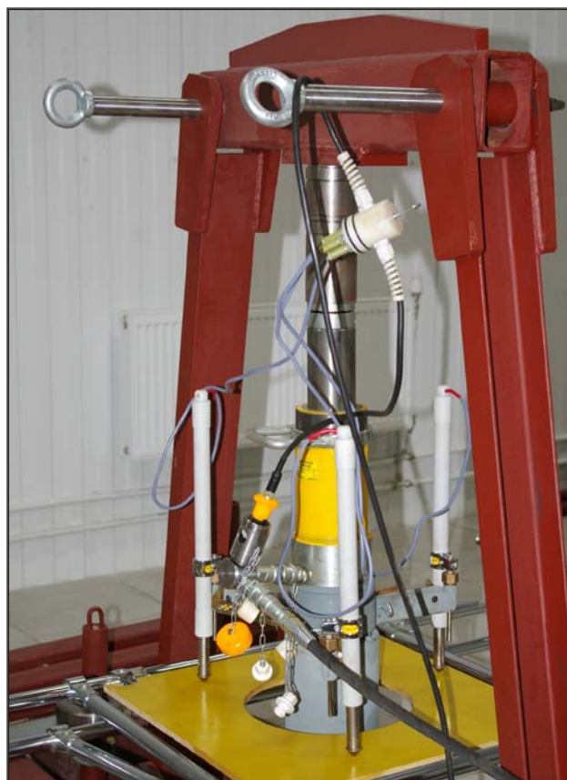
Рис.3. Узел крепления Адаптера ВД на гидроцилиндре с гидромагистралью и кабелем связи
