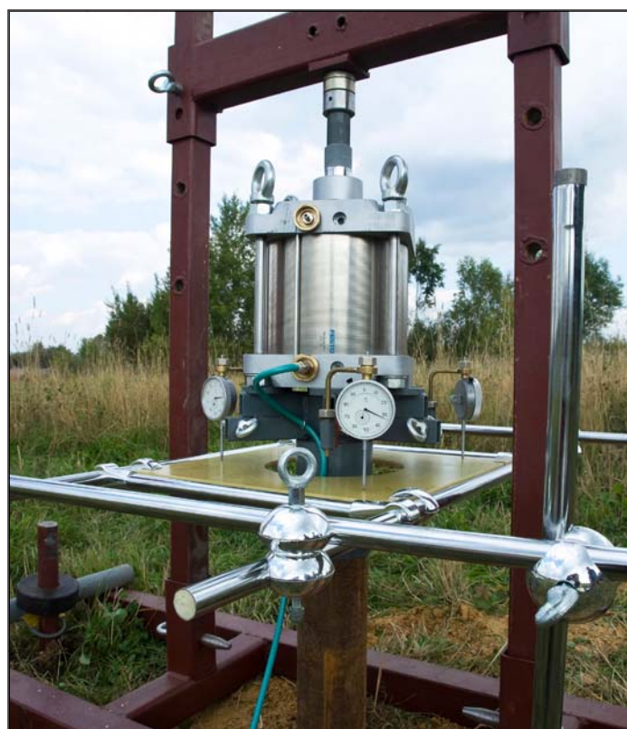
Рис.3. Позиционирование комплектующих штампа ШВ60
