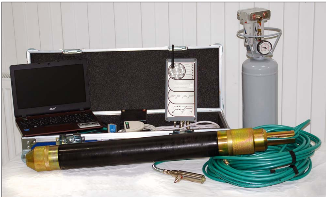
Рис.1. Общий вид комплекта КАП2 с электровоздушным прессиометром ПЭВ-89МК
